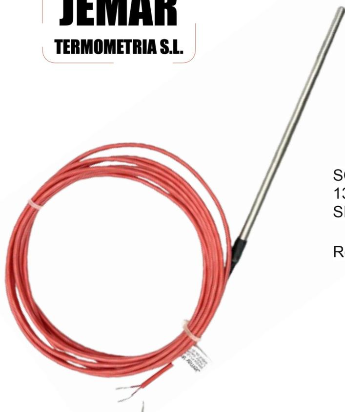
SONDA PT-100 3H FUNDA INOX DE Ø6MM L 130MM, RACORD DESLIZANTE 1/4G, CABLE SIL-SIL 3000MM
